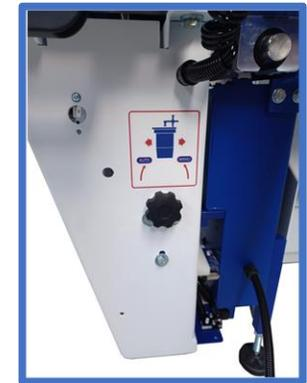
Commande de débrayage
